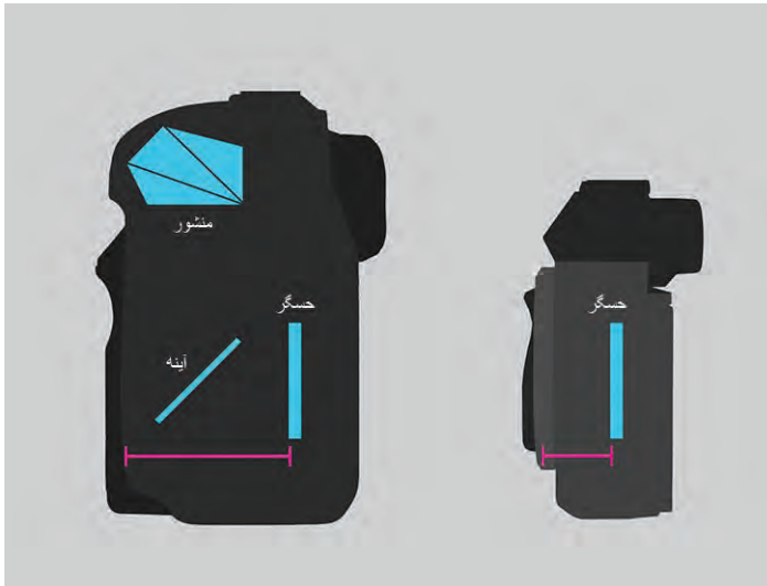
▲ تصویر ۵ | تفاوت دوربین بدون آینه و تک لنز انعکاسی
