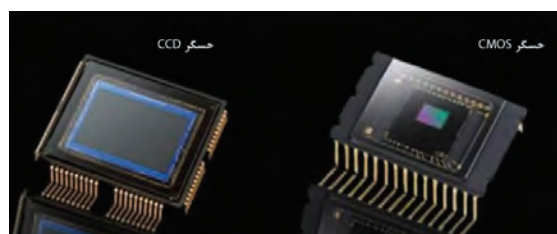
▲ تصویر ۱۰ | حسگر CCD و CMOS
