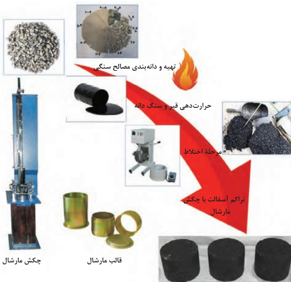
شکل ۲۹- فرایند تولید آسفالت در آزمایشگاه
