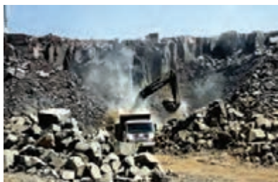
شکل ۷- نحوه تولید سنگ کوهی شکسته
