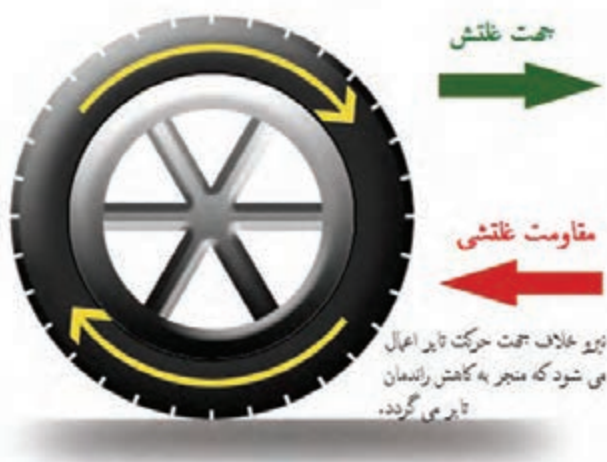
شکل ۱- جهت غلتش تأیر و مقاومت غلتشی
