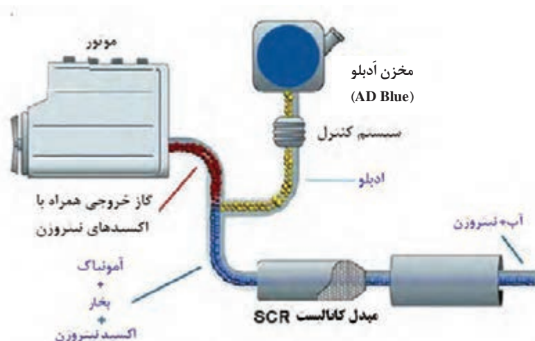
شکل ۲۸- سیستم کاتالیزت کاهش دهنده آلاینده‌ها (SCR)
