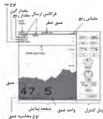
شکل ۱۸- مشخصه‌ها و نشانه‌های نمایشگر عمق یاب
