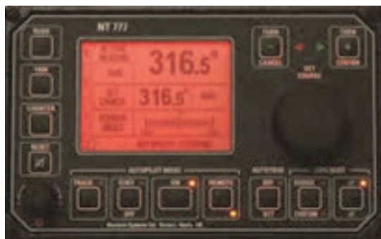
شکل ۲۷- قسمت قرار دادن راه (Set Course Unit)
