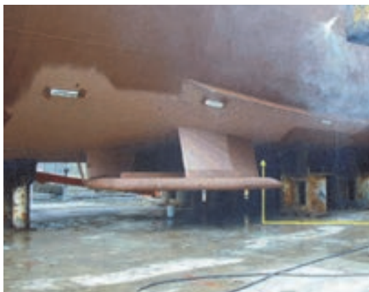
شکل ۱۷- محل قرارگیری ترانسدیوسر در پایین ترین قسمت بدنه زیرآبی کشتی
