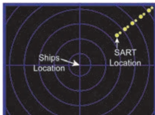
شکل ۱۹- SEARCH AND RESCUE TRANSPONDER
