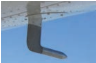
شکل ۲۴- نشان‌دهنده ولوله پیتوت (رادمتر)
