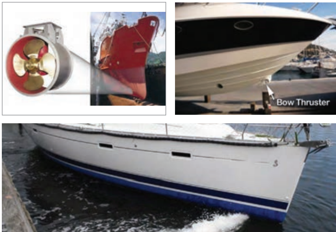
شکل ۶- پروانه‌های جانبی سینه شناور (Bow Thruster)
