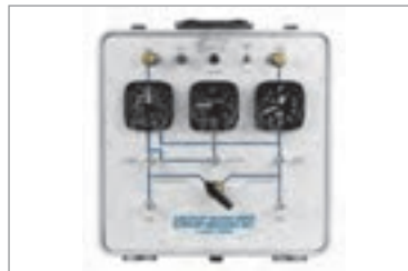
شکل ۲۴- نشان‌دهنده ولوله پیتوت (رادمتر)
