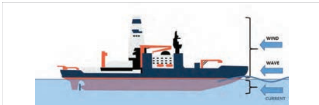
شکل ۱- عوامل بیرونی (مانند جریان آب، باد و موج) سبب تغییر مسیر حرکت و انحراف کشتی از مسیر اصلی تعیین شده می‌شوند.
