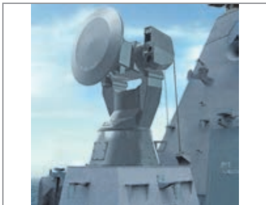
شکل ۱۱- یک نوع رادار ارتفاع یاب
