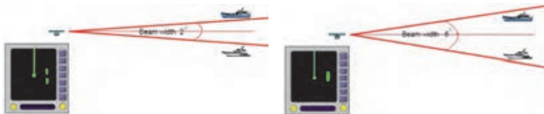
شکل ۲۰- عدم تفکیک اهداف در سمت راداری (نشان‌دهنده سمت راست) و تفکیک اهداف در سمت راداری (نشان‌دهنده سمت چپ)
