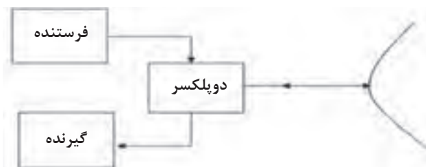
شکل ۲- بلوک دیاگرام یک رادار ابتدایی
