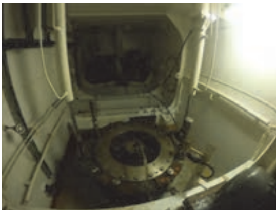
شکل ۲۷- چند نمونه میدل (ترانسدیوسر) به کاررفته در این نوع سرعت‌سنج و محل قرارگیری فرستنده آن در کف کشتی
