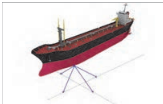
شکل ۲۸- سنجش سرعت با استفاده از چهار فرستنده در جهت‌های مختلف
