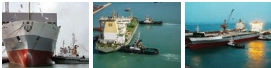
شکل ۲۹- عملیات یدک‌کشی پهلوپهلو
