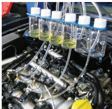
شکل ۵۵- تست اندازه‌گیری مقدار سوخت برگشتی انژکتورها
