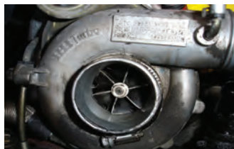
شکل ۸۳- نشست روغن در توربوشارژر
