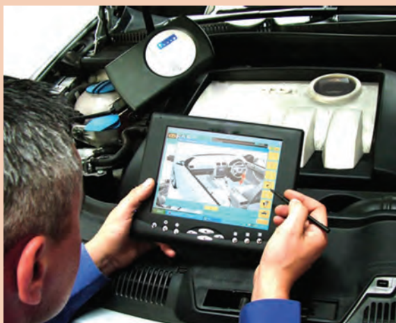
شکل ۷۵- نصب انژکتور الکترومکانیکی جدید توسط دستگاه عیب‌یاب
