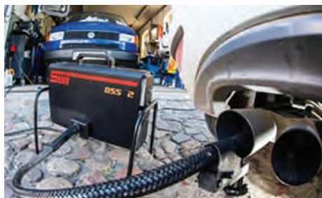
شکل ۵۸- قراردادن لوله دستگاه کنترل آلایندهای درون لوله اگزوز
