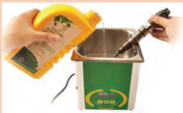
شکل ۷۸- تمیز کردن سوراخ انژکتور با دستگاه اولتراسونیک
