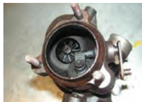
شکل ۸۳- نشست روغن در توربوشارژر
