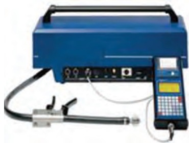
شکل ۵۹- دستگاه تست کدري دود خودروهای ديزلی
