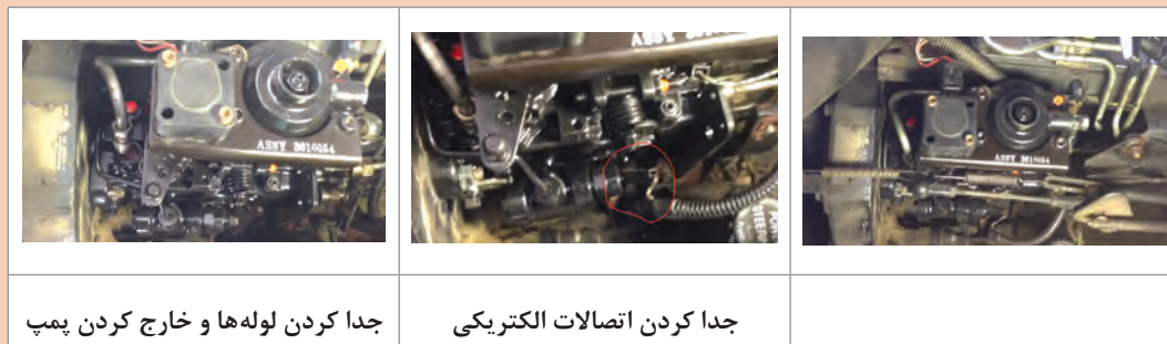
شکل ۶۳- برخی از مراحل سرویس و تعمیر پمپ انژکتور دوار
