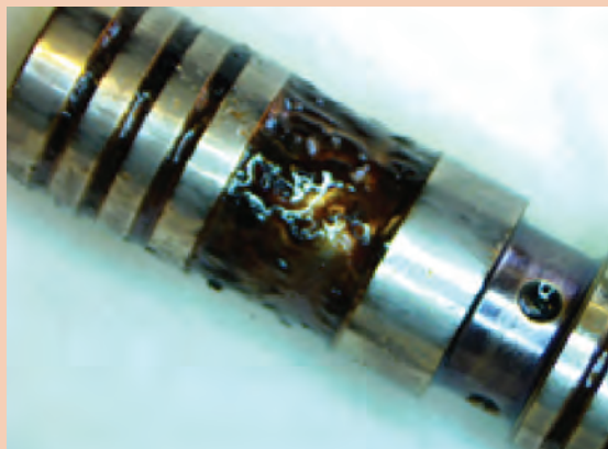
شکل ۷۶- خرابی انژکتور در اثر آب در سوخت
