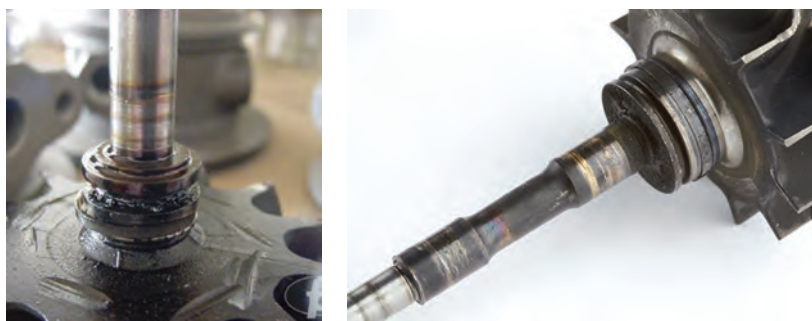
شکل ۸۵- خرابی یاتاقان‌ها و محور توربوشارژر
