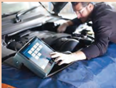
شکل ۵۲- استفاده از دستگاه عیب‌یاب
