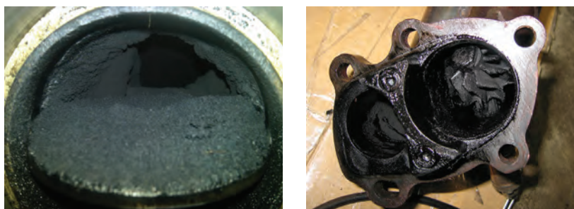
شکل ۸۴- رسوب کربن در ورودی و خروجی توربوشارژر
