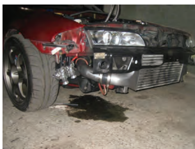
شکل ۴۹- یک نوع نشتی سیستم سوخت‌رسانی
