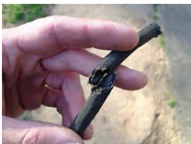
شکل ۴۹- یک نوع نشتی سیستم سوخت‌رسانی
