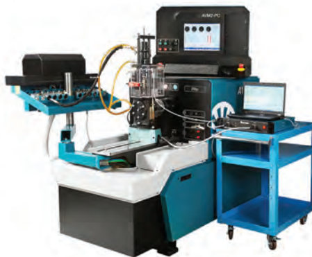
شکل ۶۹- برخی از مراحل آزمایش و تنظیم یک نوع انژکتور واحد
