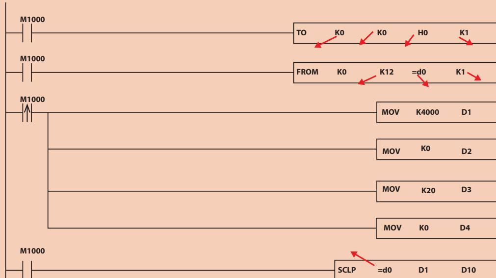
در حالت شبیه ساز جهت، باید به جای حسگر، که قرار است اطلاعات را از ورودی آنالوگ اندازه گیری کند، در نرم افزار به صورت دستی مقداردهی شود و فرایند آن به شکل زیر است:
