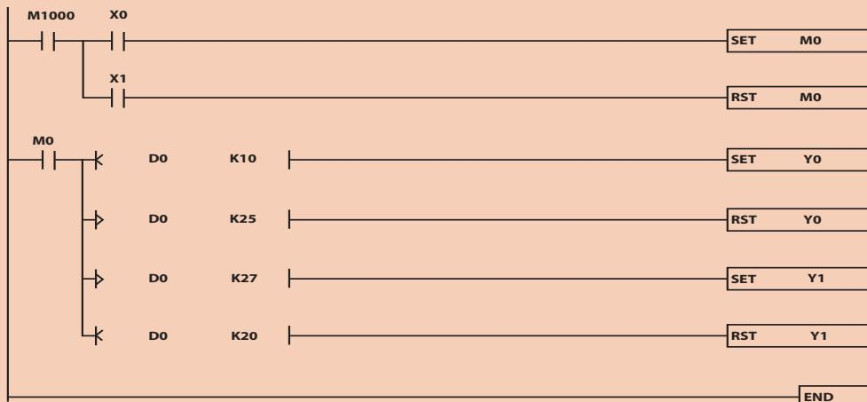
برای تست شبیه ساز در محیط برنامه، لازم است به رجیستر مقداردهی کنیم. نحوه مقداردهی پس از فعال کردن سیمولاتور، به صورت زیر است.
