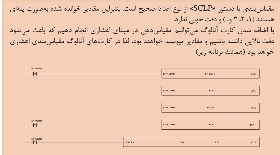
مبنای d0 باید اعشاری باشد اگر نبود باید در برنامه دستور D12 FLT D0 اجرا شده و به جای d0 در دستور مقیاس 12 قرار بگیرد.
