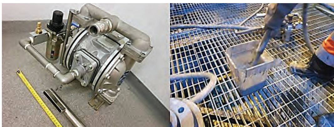
شکل ۳۳- یک پمپ نمونه گیری دیافراگمی که برای نمونه گیری از عمق سلول فلوتاسیون به کار می‌رود
