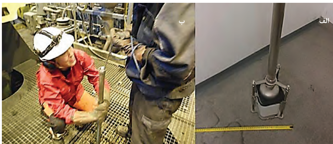
شکل ۳۲- الف) تجهیزات نمونه گیری از عمق هر سلول، ب) عملیات برداشت نمونه از عمق یک سلول، با قرار دادن نمونه گیر در عمق سلول و کشیدن طناب برای باز شدن درب آن
