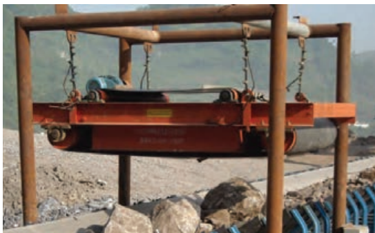
شکل ۲۶- جدا کننده های مغناطیسی معلق نوار متقاطع
