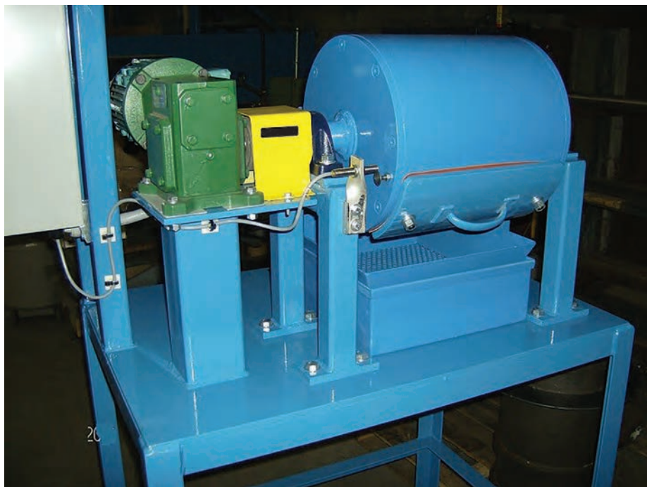
شکل ۲- آسیای گلوله ای آزمایشگاهی باند
