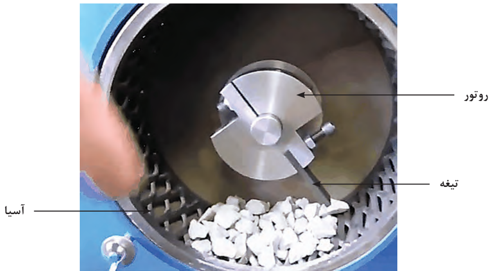
شکل ۳- نمای داخلی آسیای استاندارد ساینده‌گی باند
