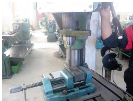
شکل ۱۳- نصب برقوروی محور دستگاه مته
