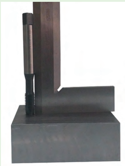
شکل ۷- کنترل عمود بودن قلاویز با سوراخ
