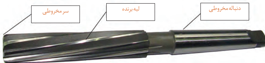
شکل ۹- ساختمان برقوی ماشینی
