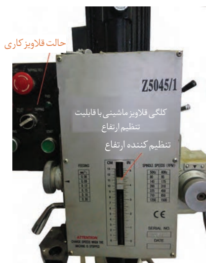
شکل ۴- کُلگی قلاویز ماشینی با قابلیت تنظیم ارتفاع
