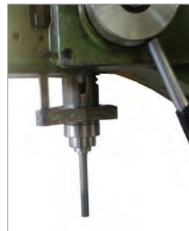
شکل ۱۳- نصب برقوروی محور دستگاه مته
