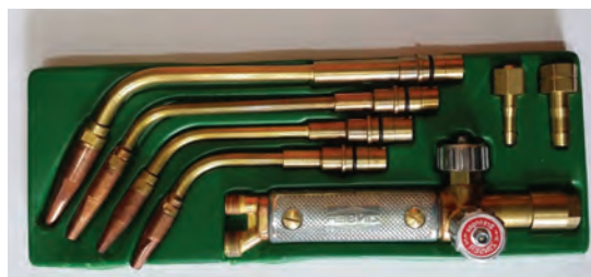
شکل ۲۰- مشعل و سر بک‌های قابل تعویض جوشکاری
