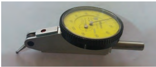
شکل ۲۵- ساعت حساس (شیطانکی) برای کنترل دایره‌ای بودن
