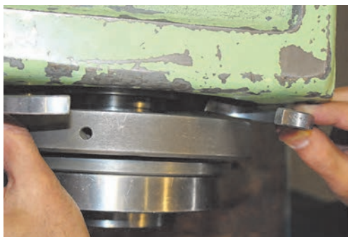
شکل ۴- خارج کردن نیم‌واشرها
