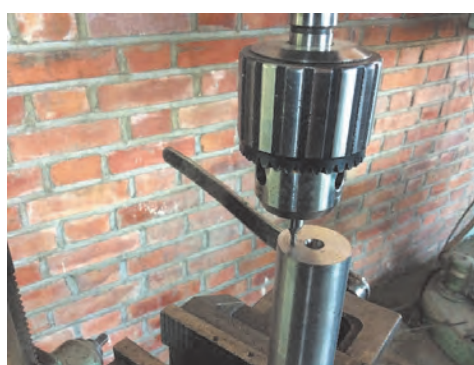
شکل ۲۳ - مته‌مرغ‌گ‌زنی به وسیله ماشین مته ستونی
