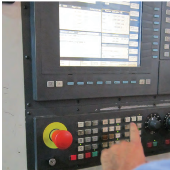
شکل ۲۴- زدن کلید TURRET
