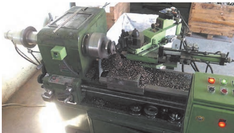
شکل ۷- عملیات کپی تراشی
