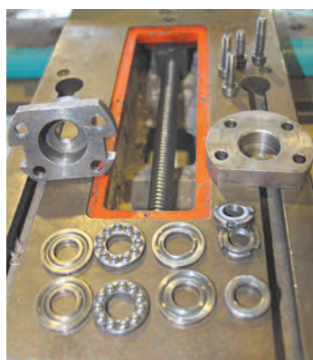
شکل ۹- یاتاقان‌بندی پیچ هادی محور عرضی
