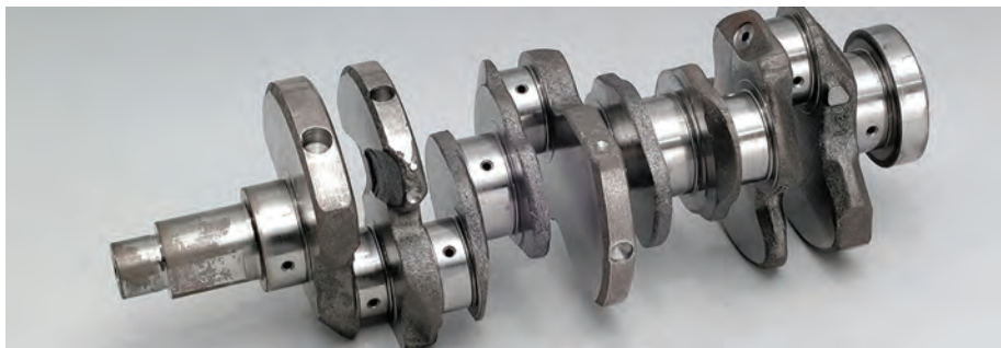
شکل ۱۶- میل لنگ آهن‌گری شده-محصول نهایی
