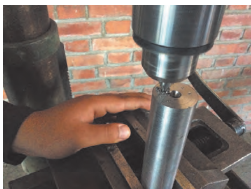
شکل ۲۳ - مته‌مرغ‌گ‌زنی به وسیله ماشین مته ستونی
