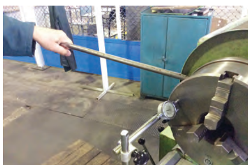
شکل ۷- اندازه‌گیری میزان لقی محوری
