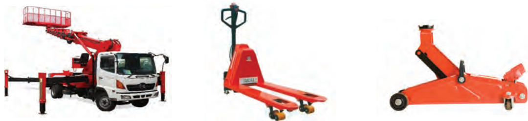
شکل ۲۵- نمونه‌های دیگری از مکانیزم‌های هیدرولیکی
