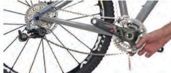
شکل ۲۱- مکانیزم‌های چرخ زنجیری
