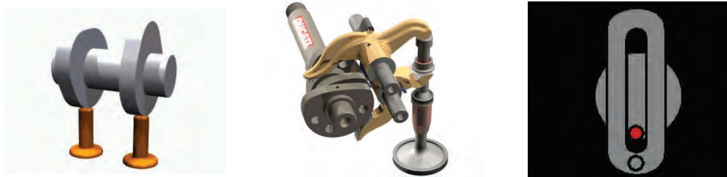
شکل ۲۸- نمونه‌هایی از مکانیزم‌های لنگی و بادامکی
