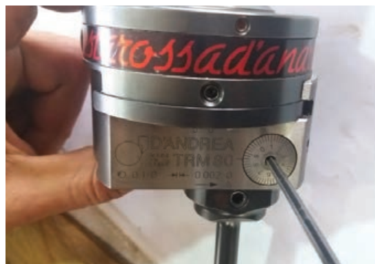
شکل ۲۰- جابه‌جایی به کمک ورنیه‌های روی ابزار
