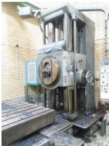
شکل ۱۰- دستگاه جیک بورینگ
