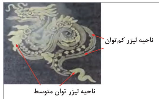
شکل ۲۹- ایجاد نقش با لیزر روی پارچه دنیم
