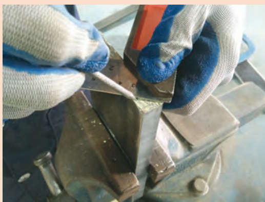
شکل ۱۴- رسم زاویه ۴۵ درجه توسط سوزن خط‌کش و گونیای فلزی
