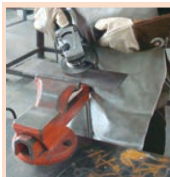
شکل ۱۲- سنگ زدن پشت ورق (ریشه جوش)
