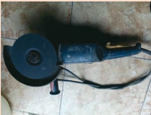
شکل ۱۳- طرز صحیح قرار دادن دستگاه سنگ زنی روی میز کار
