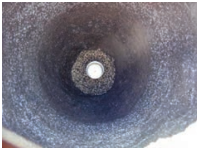
شکل ۲۱- استقرار دیسک ذوب شونده در انتهای بوتۀ
