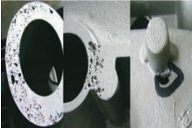
تلاطم مذاب حین ریختن آن در قالب
