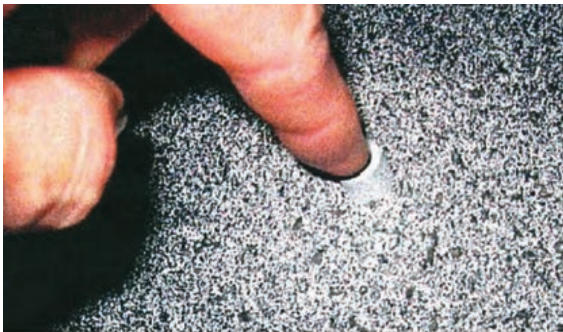
شکل ۲۲- شارژ بوتۀ و استقرار فعال‌کننده بر روی آن
