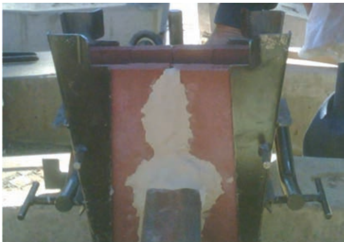
شکل ۱۹- آب بندی قالب با استفاده از گل مخصوص
