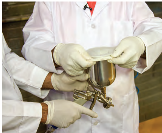
شکل ۱۸- استفاده از نظیف برای صافی
