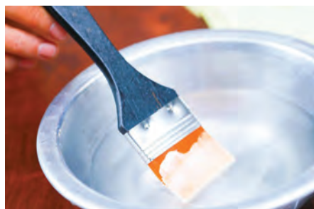
شکل ۳- شستن قلم‌مو با حلال به روش صحیح
