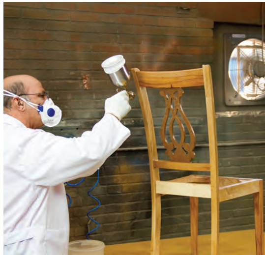
شکل ۴۳- زدن پلی استر با پیستوله
