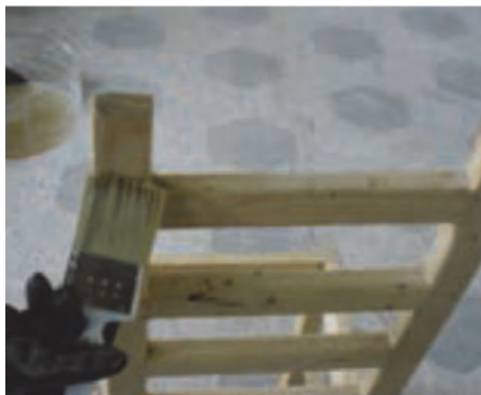
شکل ۳۹- زدن کیلر به صندلی با قلم مو
