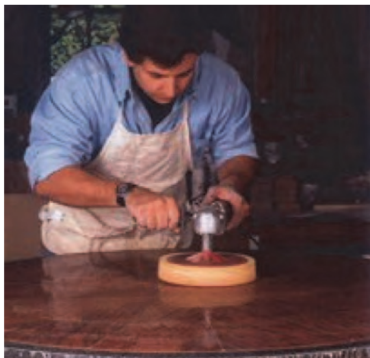
شکل ۴۷- پولیش کاری سطح پلی‌استر خورده
