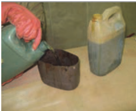
شکل ۴- رقیق کردن روغن الیف با تینر روغنی
