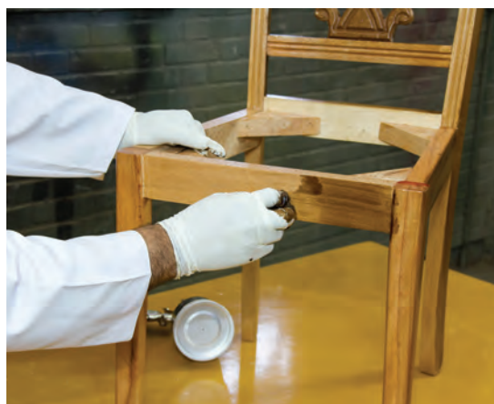
شکل ۱۰- آستری شاپان روی صندلی
