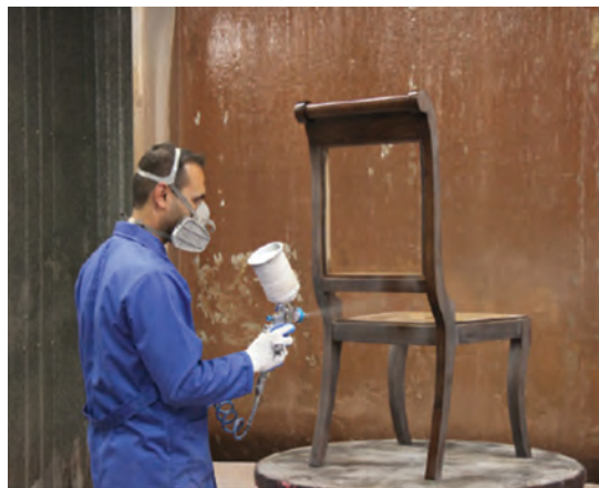
شکل ۱۹- پاشیدن رنگ با پیستوله
