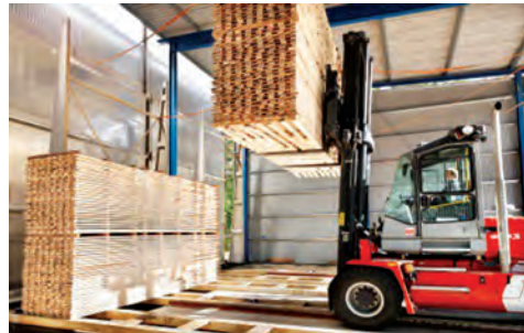
شکل ۲۳- سیستم بارگیری کوره به وسیله لیفت‌تراک
