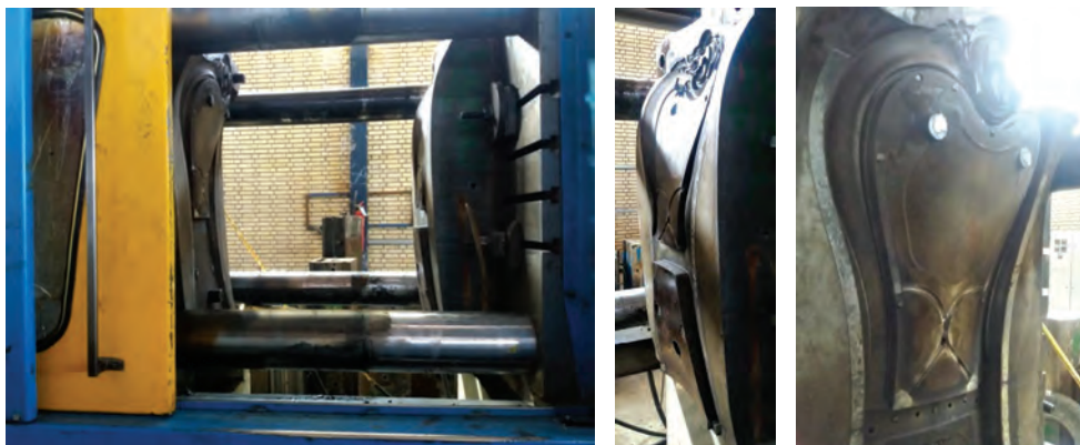
شکل ۷۴- قالب‌های مورد استفاده در ساخت مبل پلیمری
