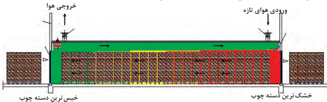
شکل ۲۵- کوره پیوسته چوب خشک‌کنی مجهز به جریان طبیعی هوا
