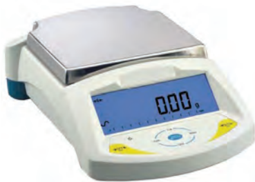
شکل ۳- وزن نمونه به وسیله ترازو با دقت ۰/۰۱ گرم
