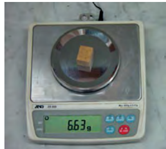
شکل ۳- وزن نمونه به وسیله ترازو با دقت ۰/۰۱ گرم
