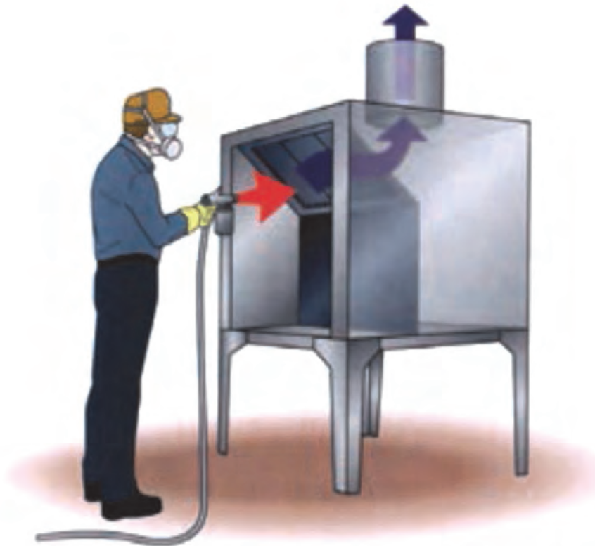
شکل ۷- استفاده از کابینت رنگ کاری
