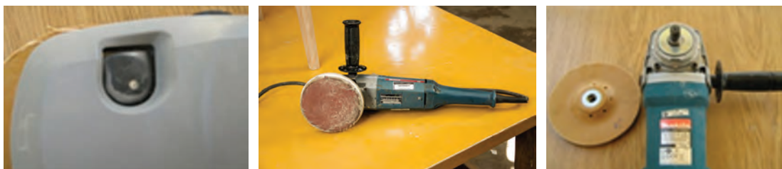
شکل ۱۷۴- اجزای سنباده دیسکی
