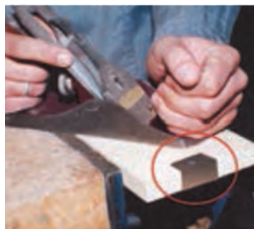
شکل ۱۱۱- احتمال برخورد رنده با میخ و یا اشیاء فلزی
