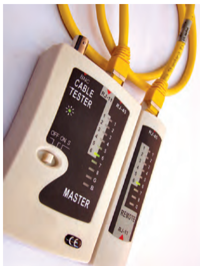
شکل ۲۰- تست کابل شبکه
