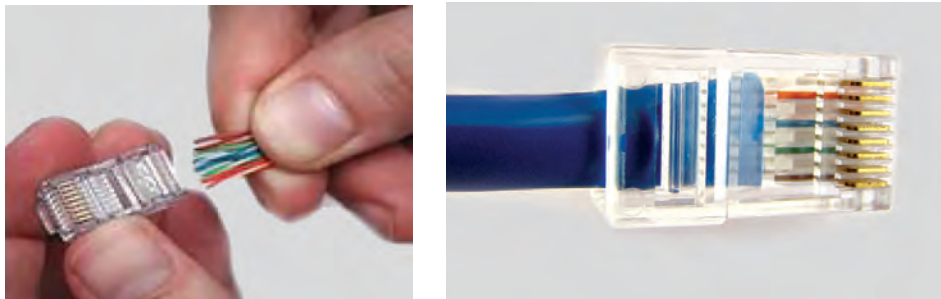
شکل ۲۸- قرار دادن سیم‌ها در سوکت
