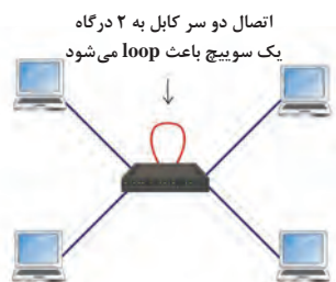
شکل ۵۹- وجود loop در سوییچ
