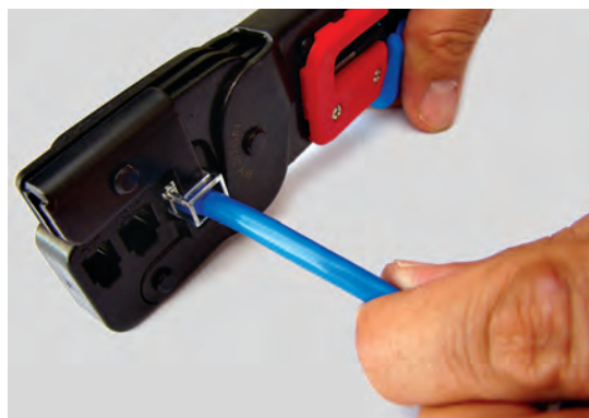
شکل ۲۹- پرس کردن سوکت RJ45
