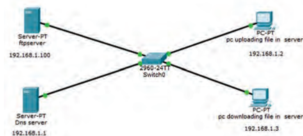
شکل ۳۶- شبیه‌سازی سرویس DNS و FTP
