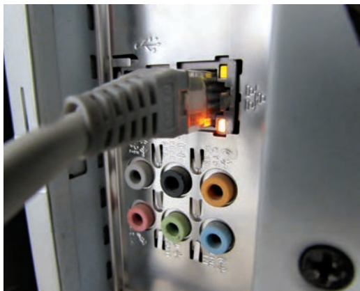
شکل ۴۳- چراغ‌های کارت شبکه
