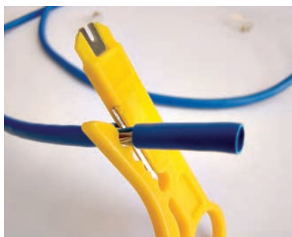
شکل ۲۵- لخت کردن سر کابل
