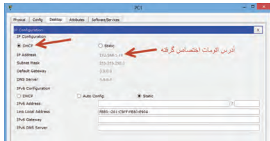
شکل ۳۰- تنظیم آدرس IP سرویس‌گیرنده‌ها در حالت خودکار
