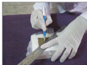
الف ب ج شکل ۷- ساخت نمونه انقباض و رسم قطرها
