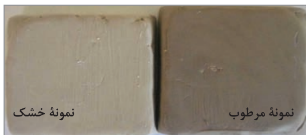
شکل ۲- تأثیر انقباض خشک در کاهش ابعاد نمونه
