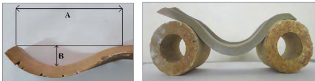
شکل ۳۶- اندازه‌گیری میزان انحنای نمونه مقاومت به پخت
