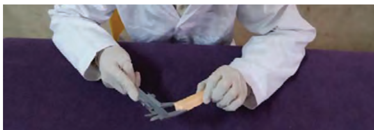
شکل ۲۵- اندازه‌گیری ابعاد مقطع شکست نمونه استحکام خمشی خشک
