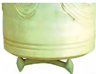
شکل ۵۶- قرار گرفتن قطعه بر روی سه پایه
