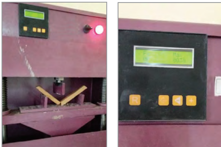
شکل ۲۴- اندازه‌گیری استحکام خمشی خشک نمونه‌ها
