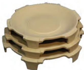
شکل ۴۴- نمونه‌ای از ستر پروفیلی پایه دار
