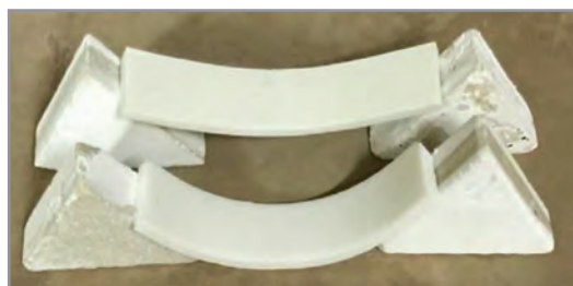
شکل ۳۰- آزمایش مقاومت پخت دو تکیه‌گاهی
