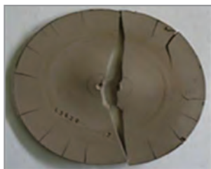
شکل ۴- ترک و تغییر شکل در یک قطعه خشک شده
