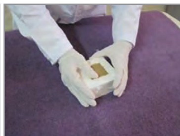
الف ب ج شکل ۷- ساخت نمونه انقباض و رسم قطرها
