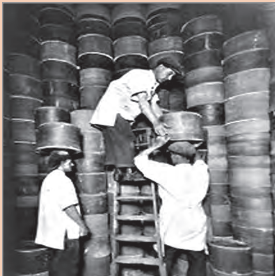
شکل ۶۷ - چیدمان ستونی ساگارها در کوره‌های سنتی
