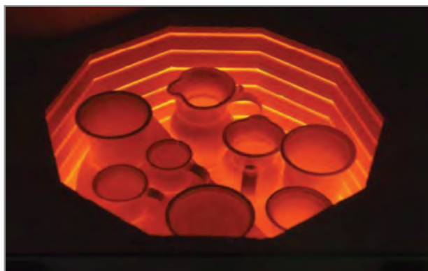
شکل ۲- بدنه‌های سرامیکی در حال پخت
