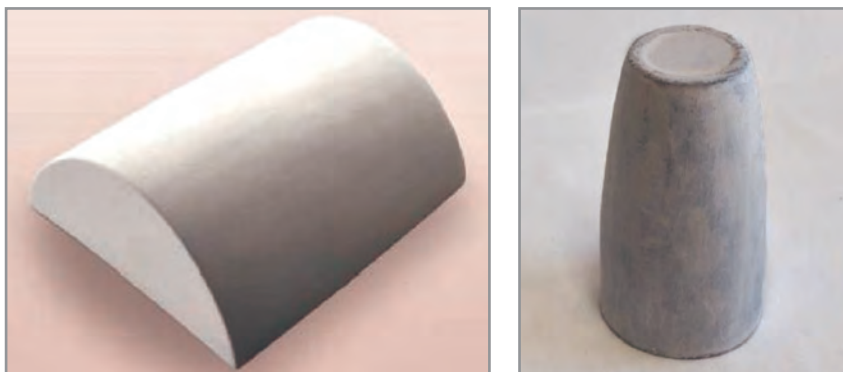
شکل ۲۷- قالب فلزی مورد استفاده در دراپینگ
