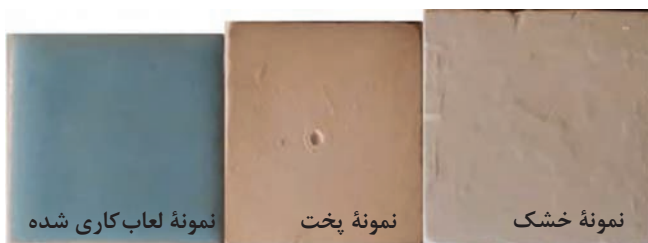
شکل ۱۲- تأثیر انقباض پخت بر ابعاد نمونه
