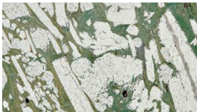
شکل ۳۲- نمونه بافت دیرگداز زیر میکروسکوپ
