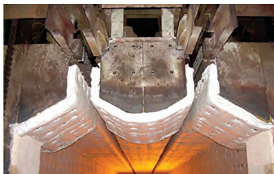
شکل ۴۵ - خم شدن عایق‌های ساخته شده از الیاف دیرگداز
