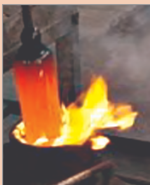
شکل ۱۲- ایجاد شعله در اثر تماس قالب آغشته به گازوئیل با مذاب
