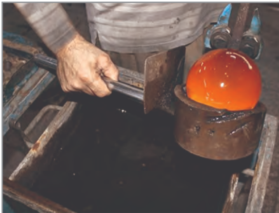
قرار گیری گوی مذاب درون قاشق
