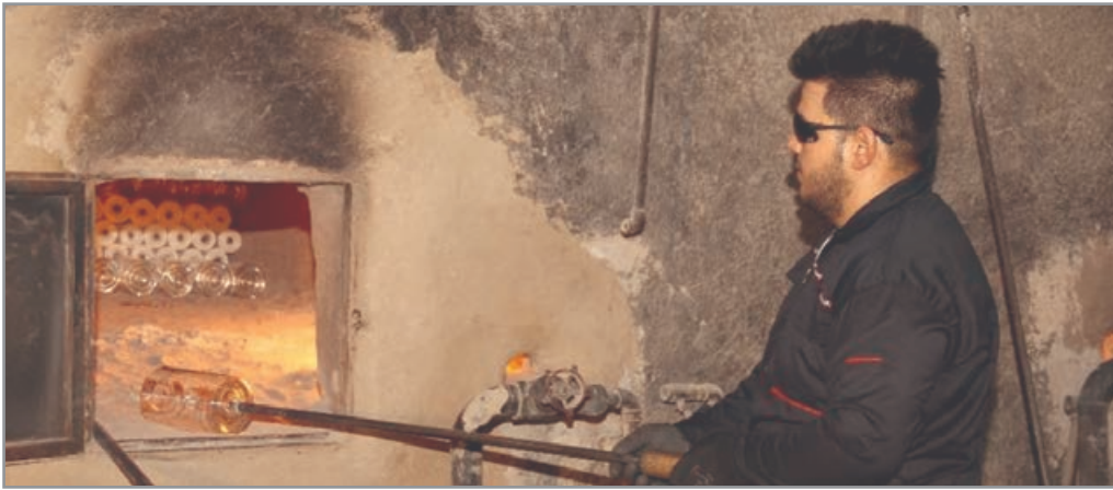
شکل ۹- قرارگیری شیشه در گرمخانه
