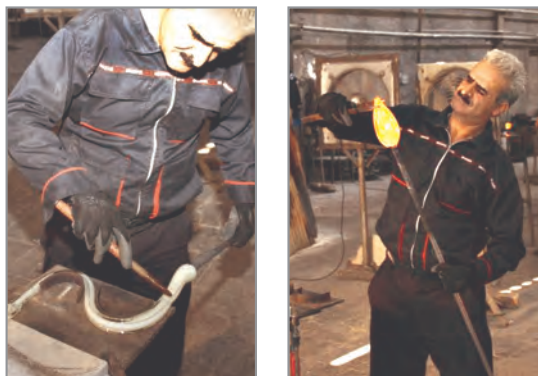
شکل ۷- شکل‌دهی گوی با کمک ابزار
