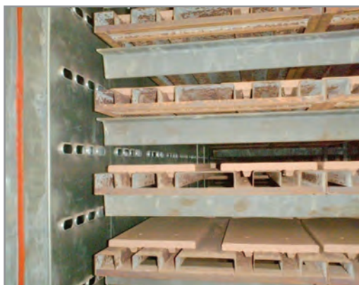
شکل ۱۶- دمش هوا از روزنه ها به قطعه
