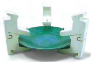
شکل ۵۴- مونتاژ چنگک پین دار برای پخت بشقاب لعاب خورده
