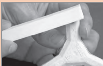
شکل ۵۹- تمیز کردن نوک پین‌ها
