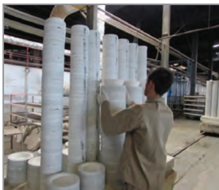
شکل ۴۹- استفاده از ساگار برای چیدمان
