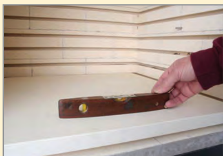
شکل ۲۸- بررسی تراز بودن کف کوره کارگاهی
