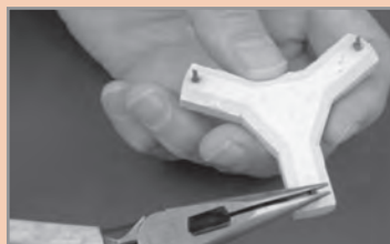
شکل ۵۸- تعویض پین‌های فلزی
