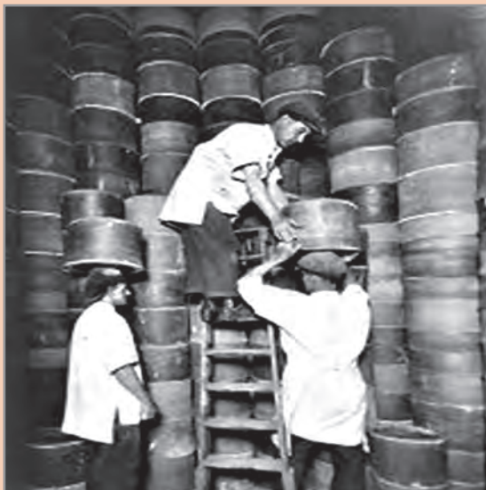
شکل ۶۷ - چیدمان ستونی ساگارها در کوره‌های سنتی
