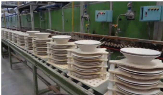
شکل ۴۲- استفاده از سترها برای پخت ظروف
