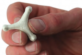
شکل ۵۵- سه پایه با پین فلزی و سه پایه تمام سرامیکی
