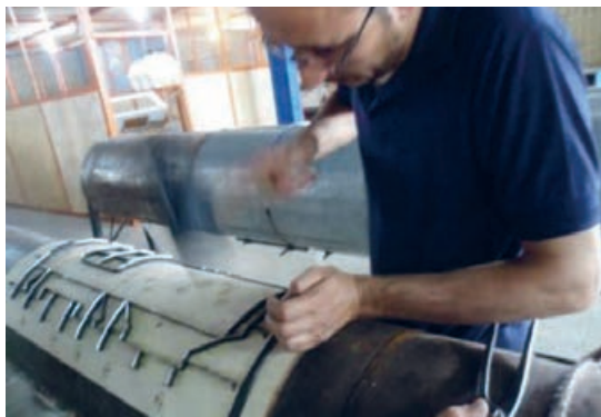
شکل ۱۳۴- جا زدن تیغ‌ها با چکش
