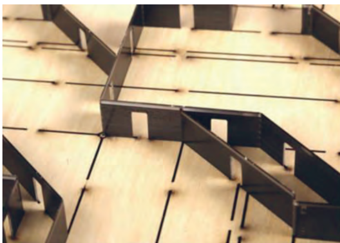
شکل ۱۴- قرارگیری تیغه‌های قالب برش در شکاف‌های ایجاد شده به وسیله دستگاه لیزر در تخته چندلایه
