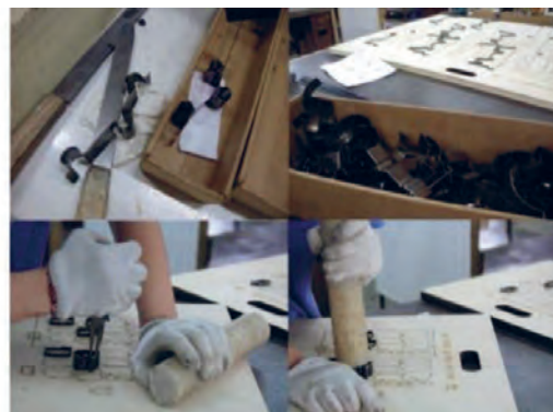
شکل ۱۰۴- قرار دادن تیغ‌ها در قالب
