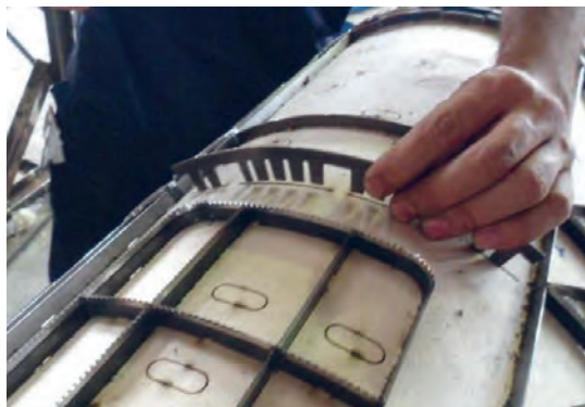
شکل ۱۳۳- قرار دادن تیغ‌ها در سیلندر
