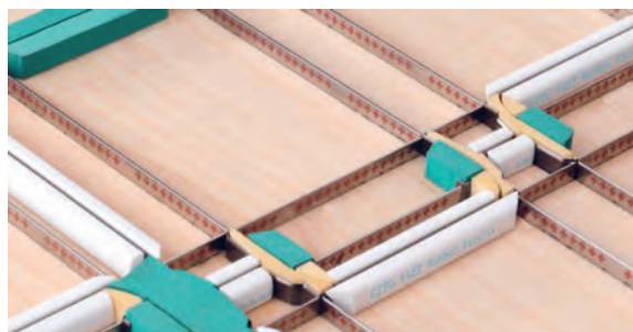
شکل ۱۴۶- هم ترازوی لاستیک‌های جداکننده تیغ‌ها
