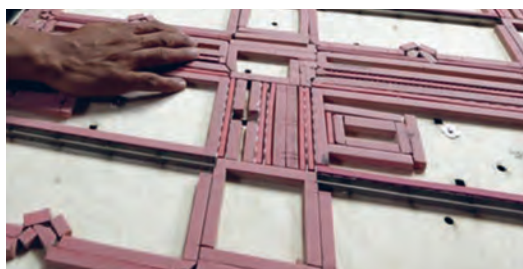
شکل ۱۲۲- قرار دادن لاستیک‌های جدا کننده روی قالب
