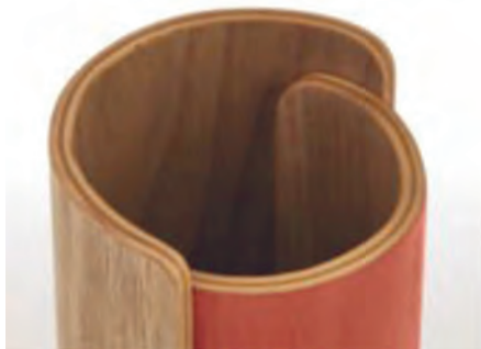
شکل ۱۳- ویژگی انعطاف پذیری تخته‌های چند لایه
