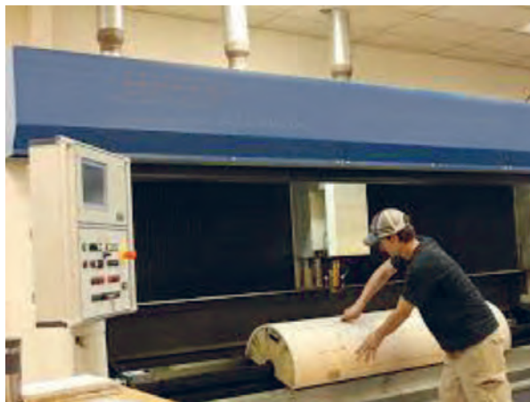
شکل ۱۲۳- قرارگیری سیلندر در دستگاه برش
