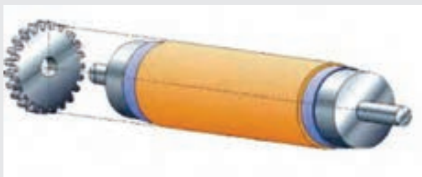
شکل ۲۹- سیلندر كليشه و چرخ دنده متناسب آن
