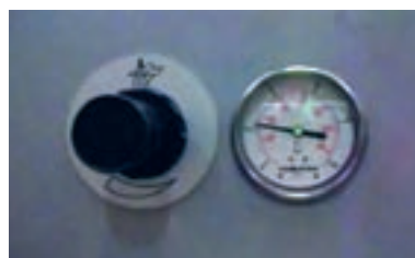
شکل ۵۴- دستگیره تنظیم فشار و گیج آن
