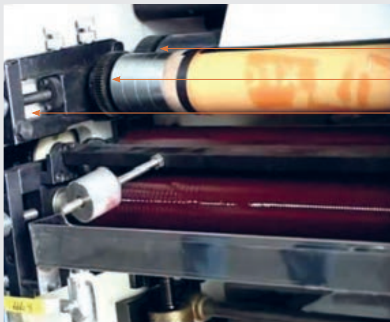
شکل ۳۰- چرخ دنده‌های دستگاه چاپ سیلندر مرکزی
