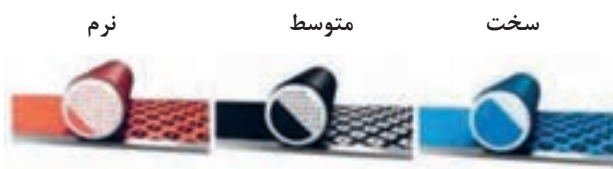
شکل ۱۱- شماتیک فشردگی ذرات فوم چسب پایه
