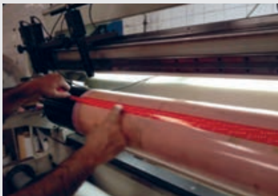
شکل ۲۸- نحوه چسباندن چسب لبه کلیشه
