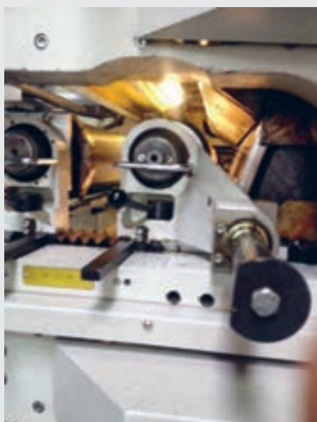
شکل ۳۶ - باز کردن و بستن قفل یک دک
