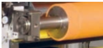
شکل ۵۹- پرس رول با شفت ثابت
