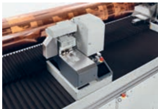
شکل ۲۵- دستگاه حکاکی لیزری مستقیم
