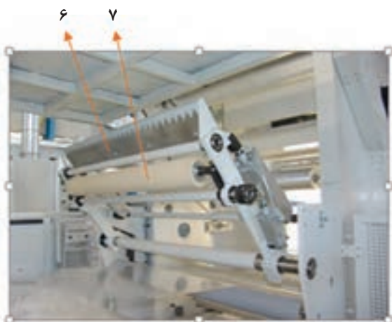
شکل ۳۱- تیغه پیوند یا (Splicer)
