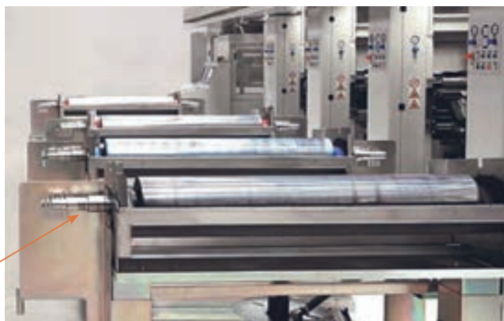
شکل ۴۴- واگن سیلندر جهت نصب در ماشین چاپ
