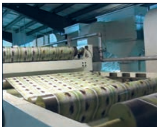
شکل ۴۹- نمونه دیگری از غلتک‌های هدایت‌کننده فیلم
