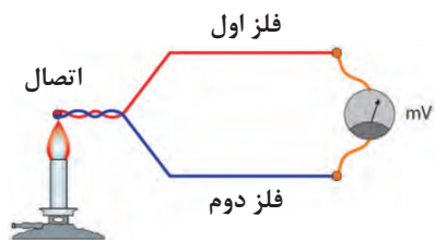
شکل ۵- نحوه اندازه گیری دما با ترموکوپل
