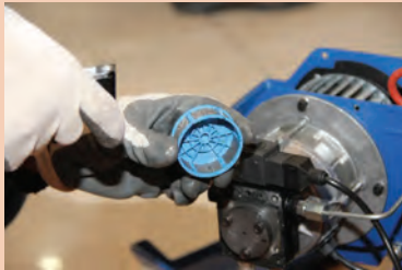
بازکردن درپوش پمپ و تمیز کردن فیلتر
