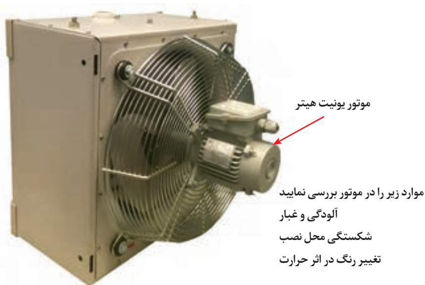
شکل ۱۸- کنترل ظاهری موتور یونیت هیتر
