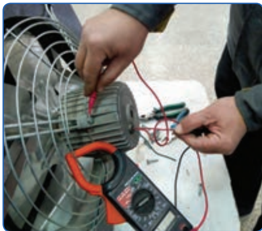
شکل ۱۹- اندازه گیری مقاومت اهمی موتور یونیت هیتر
