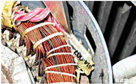
شکل ۳۶- محافظ حرارتی سیم پیچ موتور
