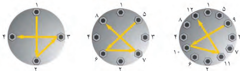
شکل ۲۳- ترتیب سفت کردن پیچ‌های فلنج
