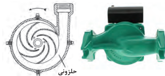
شکل ۷- پوسته حلزونی در پمپ خطی و زمینی
