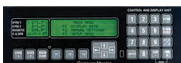
۳ واحد کنترل و نمایش (Control and Display Unit): از این واحد جهت روشن و خاموش کردن سامانه، تنظیمات، تعریف پارامترهای خروجی و... استفاده می‌شود.
