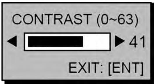
۳ کلید \* برای تنظیم کنتراست یا شفافیت صفحه‌نمایش است. با فشردن این کلید صفحه مقابل نمایش داده می‌شود و با فشردن سمت چپ و راست کلید شاسی پد، شفافیت به ترتیب کم و زیاد می‌شود. کنتراست یا شفافیت این دستگاه از صفر تا ۶۳ است و با پیش‌فرض ۴۸ تنظیم شده است. پس از انتخاب شفافیت دلخواه، با کلید ENT روی عدد دلخواه ثبت خواهد شد.
