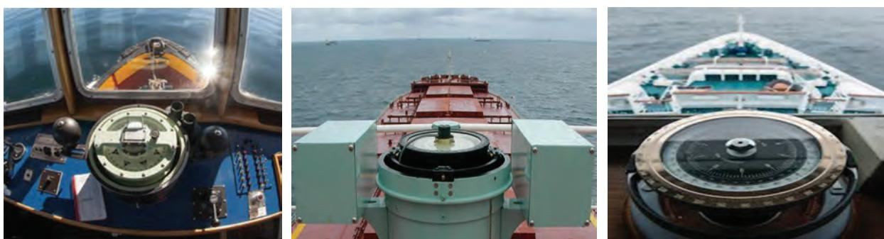
شکل ۱- چند نمونه قطب‌نماهای مغناطیسی مورد استفاده در شناورها
