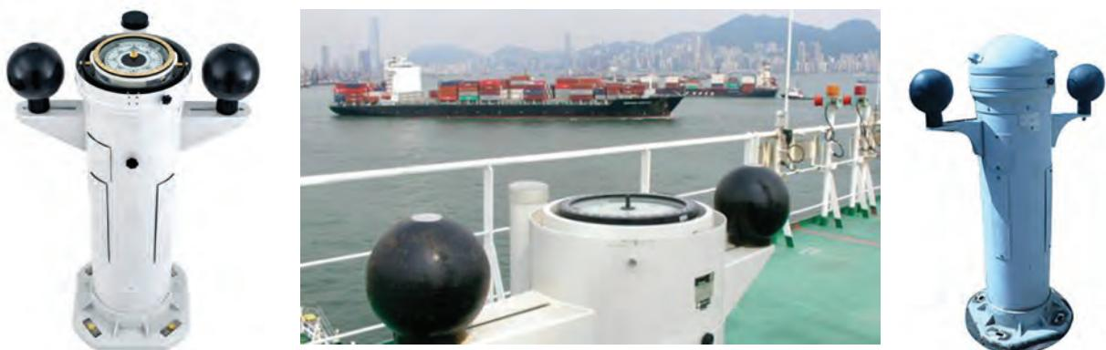
شکل ۲- پایه و گویچه‌های تنظیم کننده قطب‌نمای مغناطیسی
