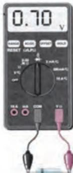
در مولتی مترهای دیجیتالی قطب مثبت مولتی متر به قطب مثبت باتری داخلی و قطب منفی آن نیز به قطب منفی این باتری وصل است. در مولتی مترهای دیجیتالی قسمتی به نام تست دیوود وجود دارد که هنگام استفاده از آن برای دیوودهای ژرمانیومی ولتاژ  $200 \text{ mV}$  تا  $30 \text{ mV}$  ولت و برای دیوودهای سیلیکونی  $60 \text{ mV}$  تا  $70 \text{ mV}$  ولت را نشان می‌دهد. این ولتاژ همان ولتاژ بایاس موافق دو سر دیوود است. در شکل (۶) آزمایش دیوود با مولتی متر دیجیتالی در یک حالت نشان داده شده است.
