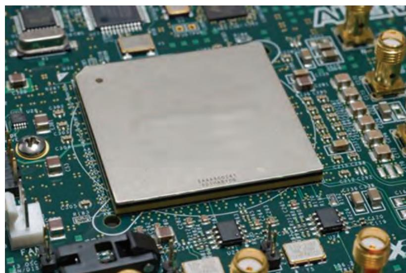
شکل ۳۵- یک نمونه تراشه FPGA
