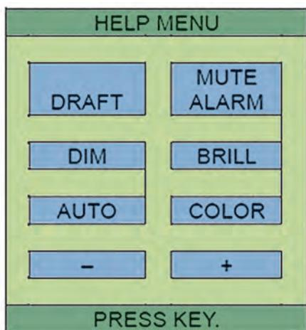
شکل ۳۴- نمایی از نمایشگر عمق‌یاب در حالت HELP
