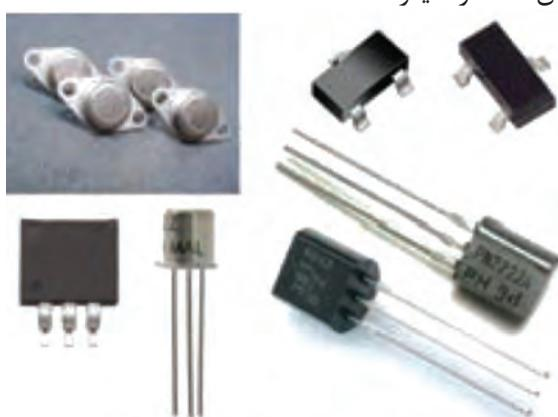
شکل ۳۴- تصویر ظاهری از چند نمونه ترانزیستور
