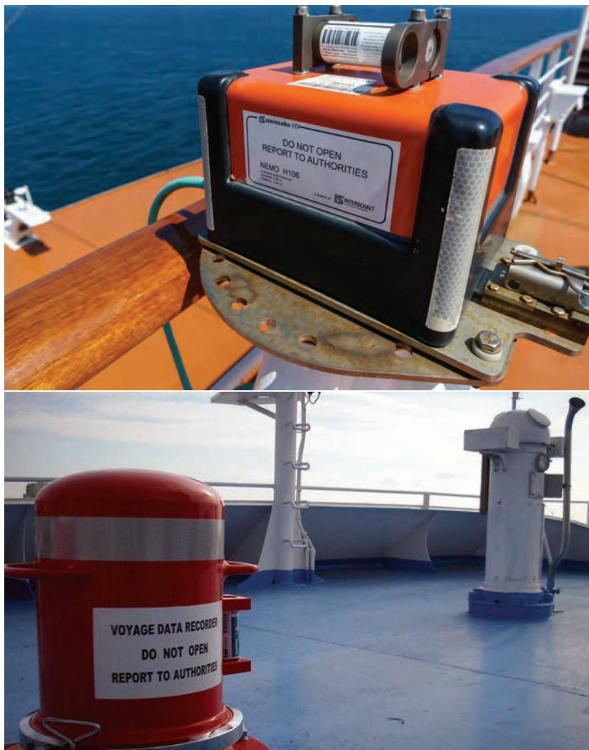
شکل ۱۸- کپسول‌های حاوی DRU نصب شده در عرشه آزاد
