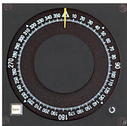
شکل ۸- تکرارکننده جايرو Console Repeater Compass
