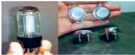
شکل ۱- مقایسه شکل ظاهری ترانزیستور و لامپ
