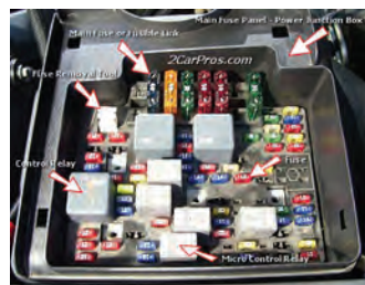
فیوز روی بُرد الکترونیکی
