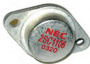
ترانزیستور قدرت با بدنه فلزی
