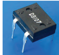
پل یک سوساز در بسته بندی آی‌سی
