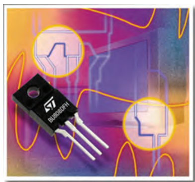
ترانزیستور قدرت با بدنه پلاستیکی و گرماگیر
