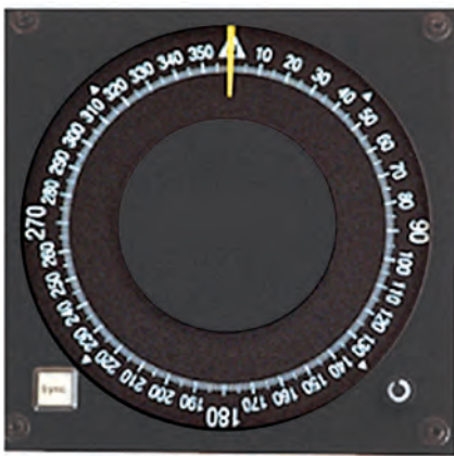
شکل ۸- تکرار کننده جایرو Console Repeater Compass
