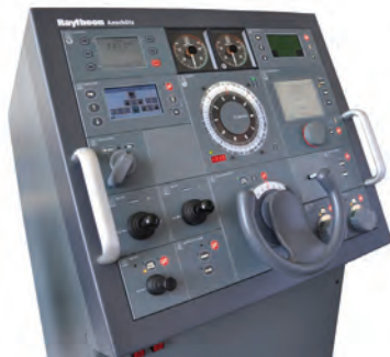
شکل ۲۶- سامانه هدایت خودکار (اتوپیلوت) در کشتی‌ها
