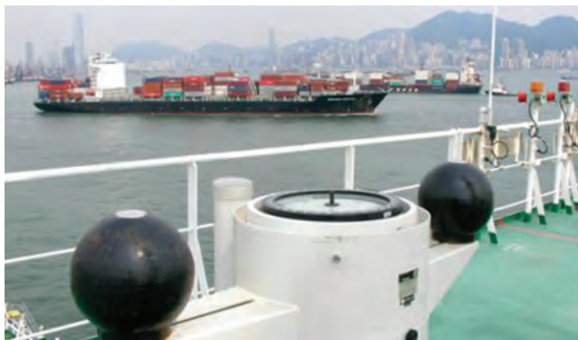
شکل ۲- پایه و گویچه‌های تنظیم‌کننده قطب‌نمای مغناطیسی
