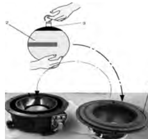
شکل ۷- اجزای OUTERSPHERE جایرو مدل STD۲۲
