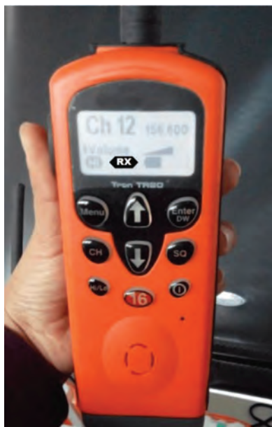
شکل ۳۷- دستگاه VHF در حالت دریافت (RX)
