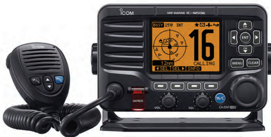
شکل ۵ – نمونه دستگاه VHF ثابت دریایی
