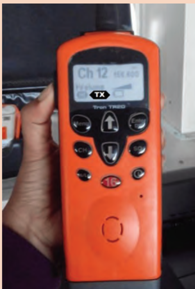
شکل ۳۶- VHF در حالت ارسال (TX)
