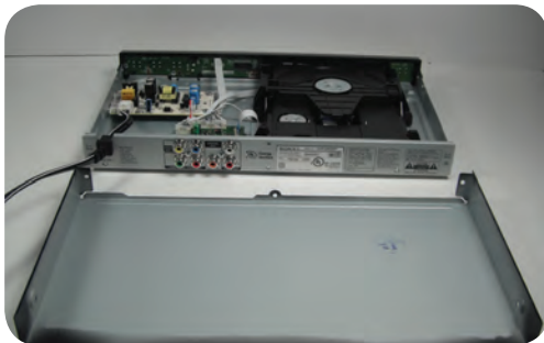
شکل ۶-۱۷ قاب پایینی جدا شده است
