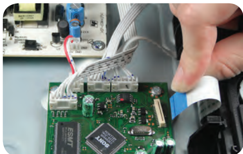
شکل ۱۸-۶ آزادسازی کابل پردازشگر
