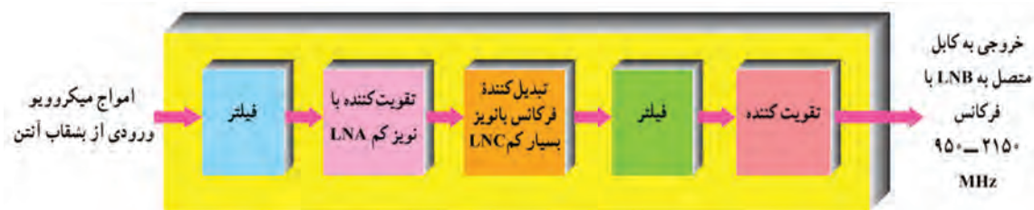
شکل ۴-۲۶ بلوک دیاگرام ساده LNB
