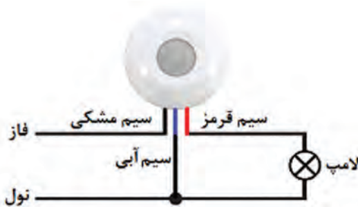
شکل ۲۸-۲ اتصال حسگر حرکتی به شبکه و لامپ
