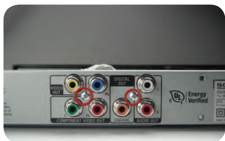
شکل ۲۲-۶ باز کردن پیچ‌نهایی برد پردازشگر
