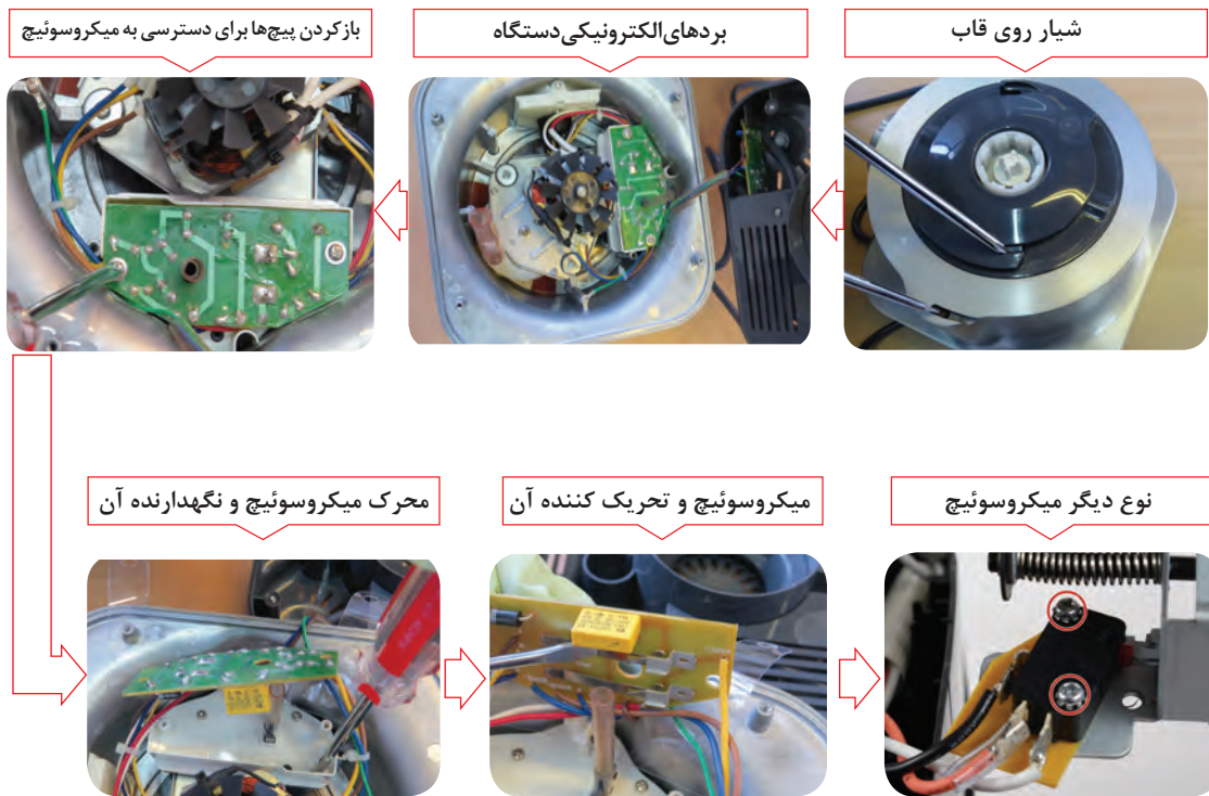
شکل ۲۵-۱- اینفوگرافی جدا کردن میکروسوییچ
