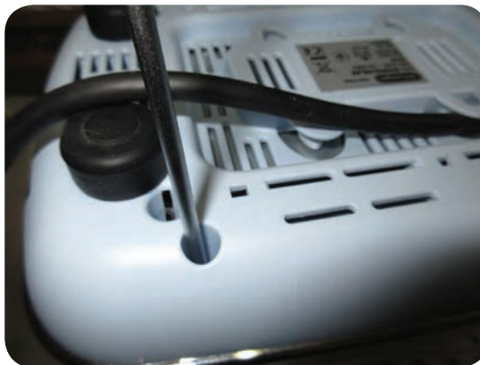
شکل ۶-۴۲ تشخیص نوع و محل پیچ‌های باز شده
