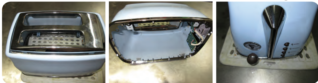
شکل ۶-۴۴ جدا کردن حلقه پلاستیکی شکل ۶-۴۵ جدا کردن کاسه پلاستیکی بالا شکل ۶-۴۶ قسمت زیرین توستر
