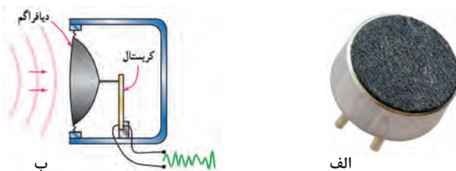
شکل ۱۶-۵- میکروفون کریستالی و ساختمان داخلی آن
