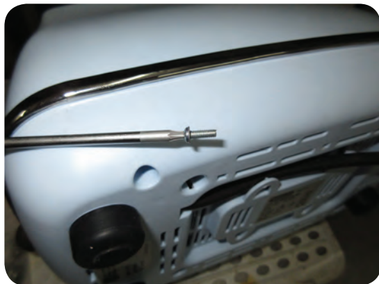
شکل ۶-۴۳ استفاده از ابزار خاص برای پیچ‌های ویژه
