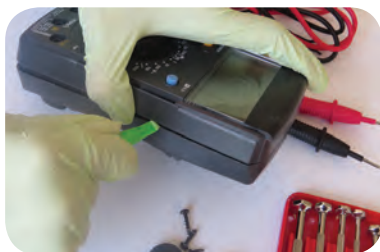
شکل ۱۵-۱- جدا کردن دو قسمت بدنه
