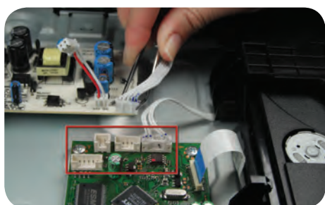
شکل ۲۰-۶ جدا شدن تمامی سوکت‌ها از برد
