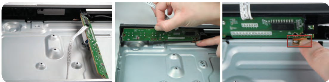
شکل ۶-۳۰ زائده سمت راست شکل ۶-۳۱ فشار دادن زائده و خارج کردن برد شکل ۶-۳۲ پنل ديمونتاژ شده
