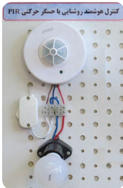
شکل ۲۹-۲ نحوه سیم‌کشی حسگر حرکتی PIR
