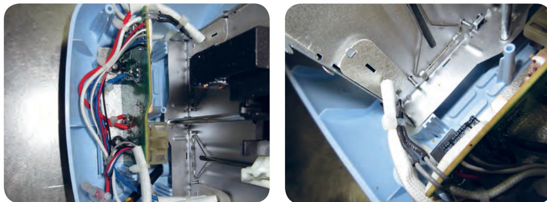
الف شکل ۶-۴۹ محل قرار گرفتن حسگر حرارتی
