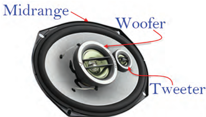
شکل ۹-۵ - مجموعه‌ای از سه نوع بلندگو
