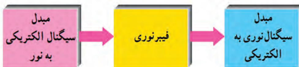
شکل ۴-۱۰- اساس یک سامانه فیبر نوری
