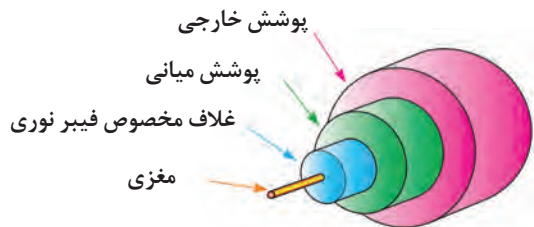
شکل ۴-۸- فیبر نوری و اجزای آن
