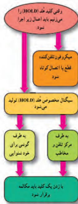
شکل ۳۲-۵- عملکرد مدار هلد
