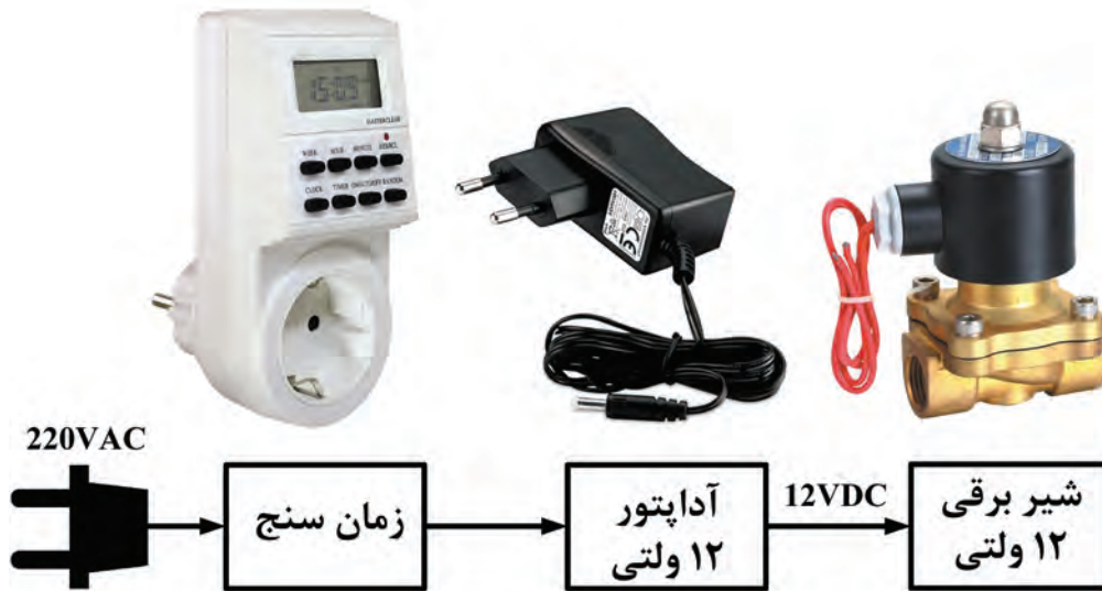
شکل ۲-۴۸- نصب شیر برقی ۱۲ ولت
