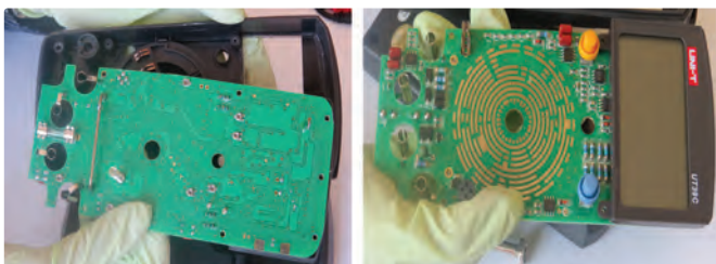
شکل ۱-۱۷- مولتی متر باز شده
