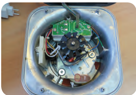
شکل ۲۴-۱- موتور، برد الکترونیکی و پروانه
