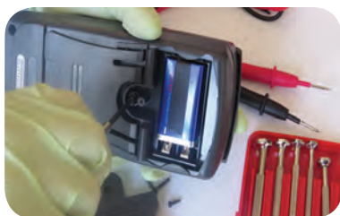
شکل ۱-۱۴- باز کردن پیچ‌ها و آزادسازی خارها
