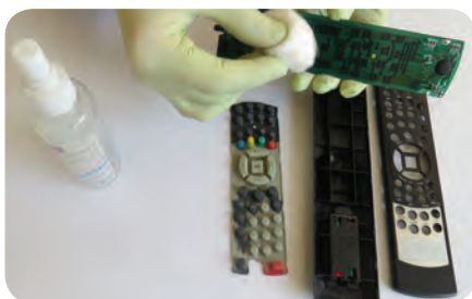
شکل ۱-۱۰- تمیز کردن کنتاکت‌ها با الکل
