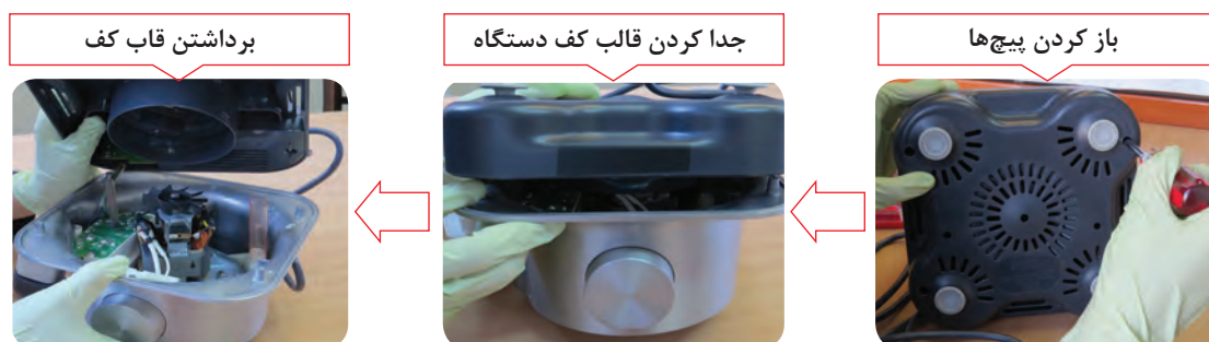
شکل ۲۲-۱- اینفوگرافی باز کردن کف دستگاه
