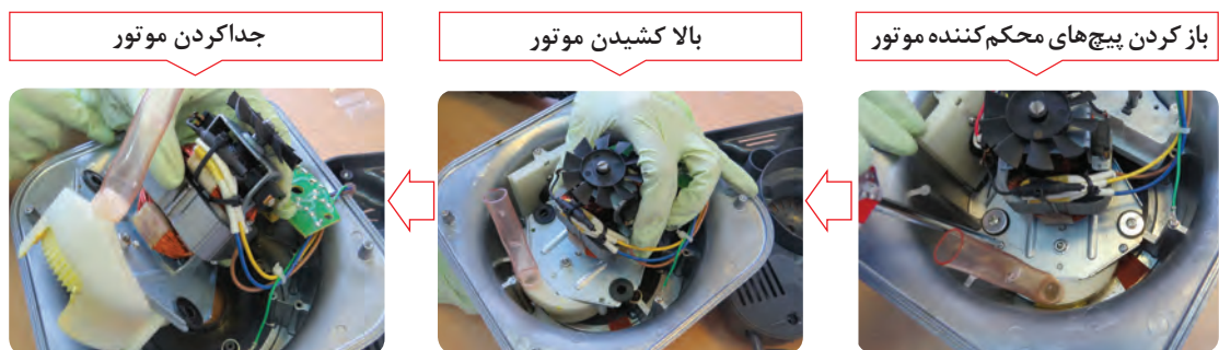
شکل ۲۶-۱- اینفوگرافی جدا کردن موتور
