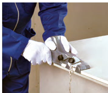
شکل ۱-۱۹۱- پخ زدن لبه‌ها
