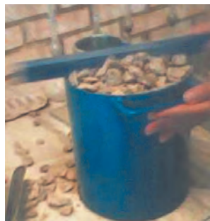
شکل ۶ ▲ آزمایش چگالی سنگ‌دانه‌ها
