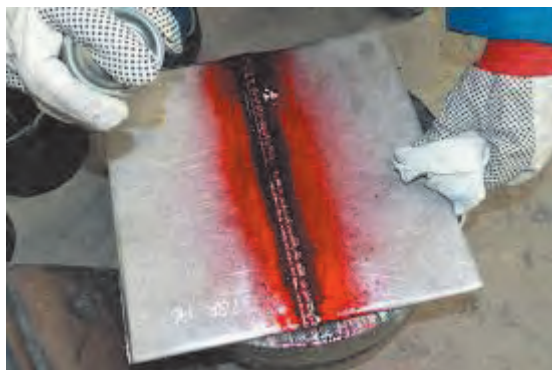
شکل ۹۰ ▲ بازرسی به وسیله مایع نافذ
