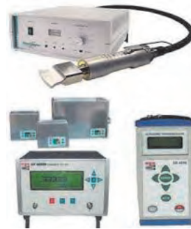
شکل ۹۱ ▲ بازرسی به روش اولتراسونیک
