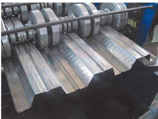
شکل ۳۵ ▲ روش تولید ورق عرشه فولادی
