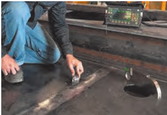
شکل ۹۱ ▲ بازرسی به روش اولتراسونیک
