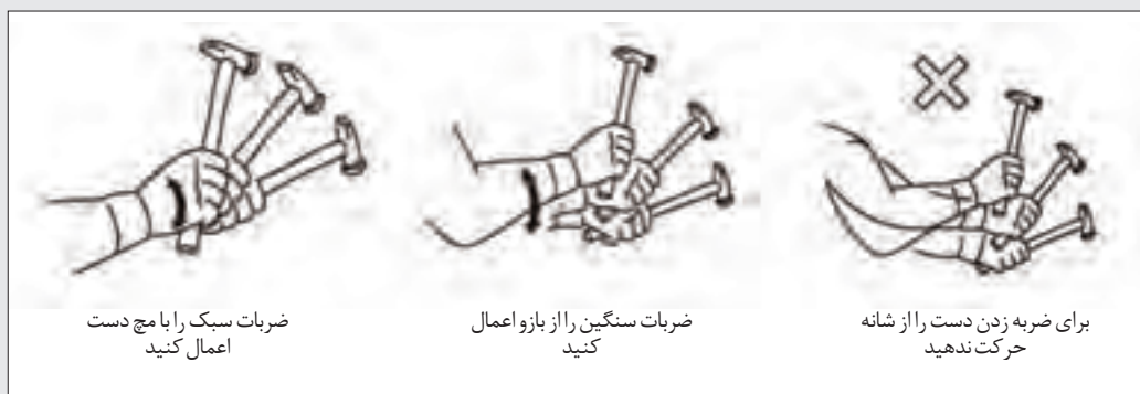
شکل ۵۰- روش ضربه زدن با چکش
