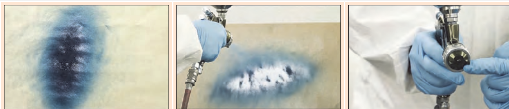
شکل ۶۶- تنظیم جهت پاشش
