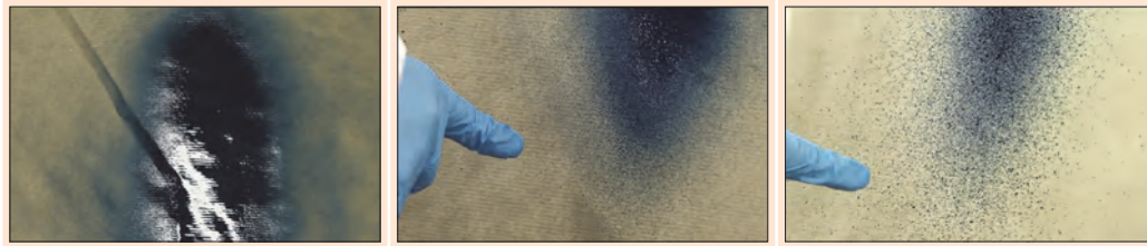
شکل ۶۴- با افزودن فشار، خروجی پیستوله یکنواخت شده است.
