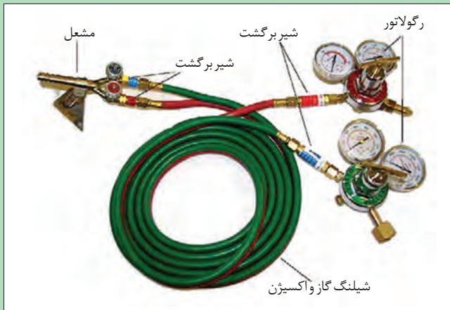
شکل ۱۸- محل نصب سوپاپ‌های یک طرفه (شیر برگشت)
