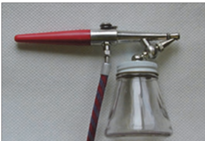
شکل ۶۲- ایربراش یا قلم رنگ پاش (Airbrush)
