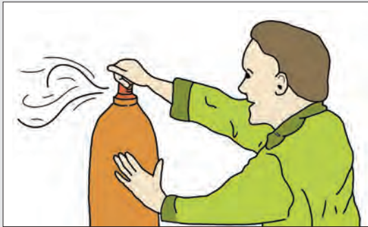
شکل ۱۳- روش تمیز کردن محل اتصال کپسول
