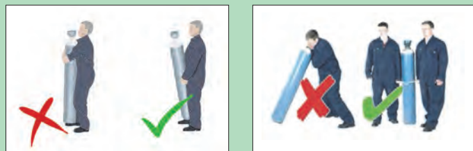
شکل ۱۲- حمل و نقل ایمن کپسول‌ها
