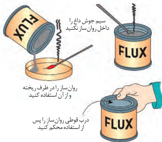
شکل ۲۸- روش استفاده از روان ساز
