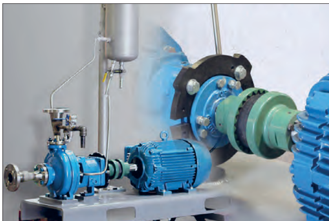
شکل ۸- انتقال قدرت مستقیم از موتور به دستگاه
