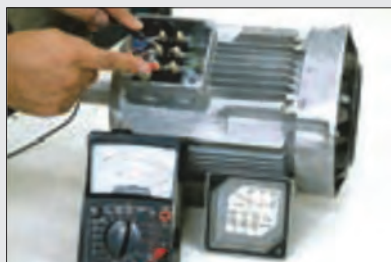
شکل ۶- آزمایش الکتروموتور با استفاده از مولتی متر
