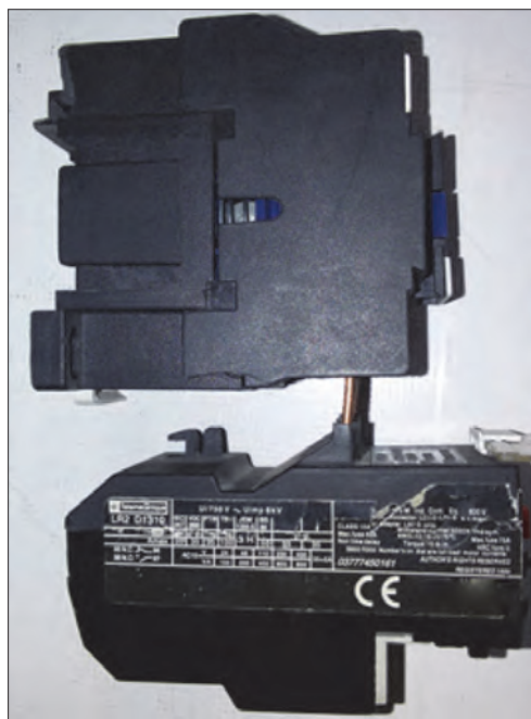
ج) اتصال بی‌متال زیر کنتاکتور
