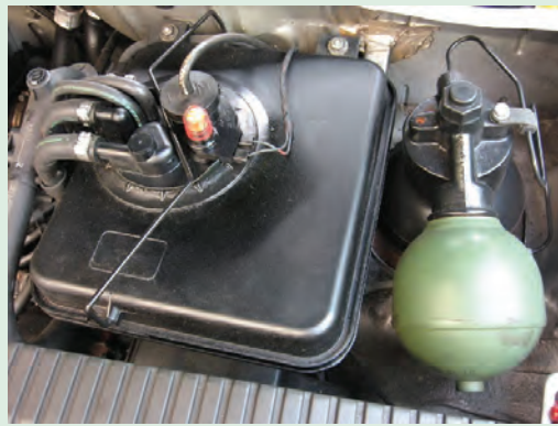
شکل ۳۶- آکومولاتور سیستم تعلق اتومبیل زانتیا
