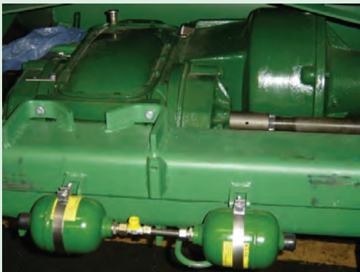
شکل ۳۷- آکومولاتور سیستم تعلیق هد کمباین جاندر ۱۰۵۵
