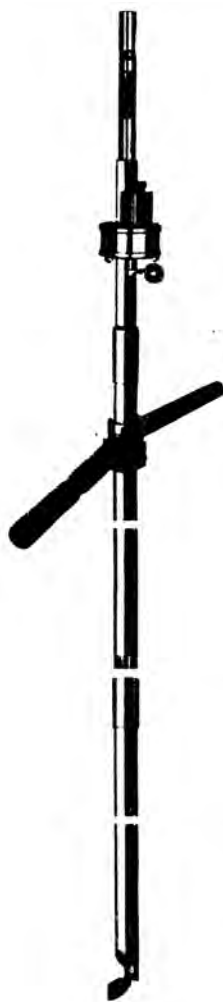
شکل ۵-۳- سوند فستوکسین برای قرص‌گذاری در داخل توده غله
